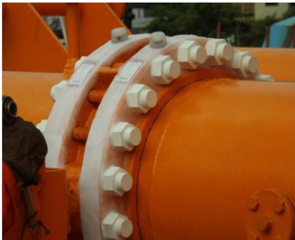
O **F-Detec<sup>®</sup>** é um dispositivo construído em policarbonato e viton, dotado de um microcircuito eletrônico e um microprocessador blindado, capaz de detectar qualquer tipo de vazamento por falha nas juntas das uniões flangeadas.
